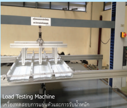
Load Testing การทดสอบการแอ่นตัวและการรับน้ำหนักสูงสุดของแผ่น
